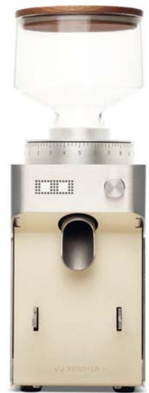
ZURIGA „G2-GBW“ MIT AN BORD: 54-mm-Mahlscheiben aus gehärtetem Edelstahl, stufenlose Mahlgradverstellung, 1.200 Umdrehungen pro Minute und eine integrierte Waage, die das Gewicht des Kaffees mit einer Genauigkeit von 0,1 g misst.
